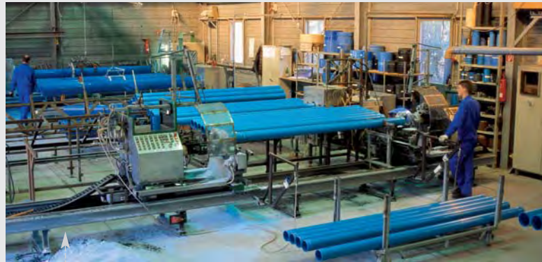
Gewindeschneiden an Kunststoffrohren mit computer-gesteuerten Sondermaschinen
