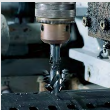
Lochen von PEHD-Rohren
